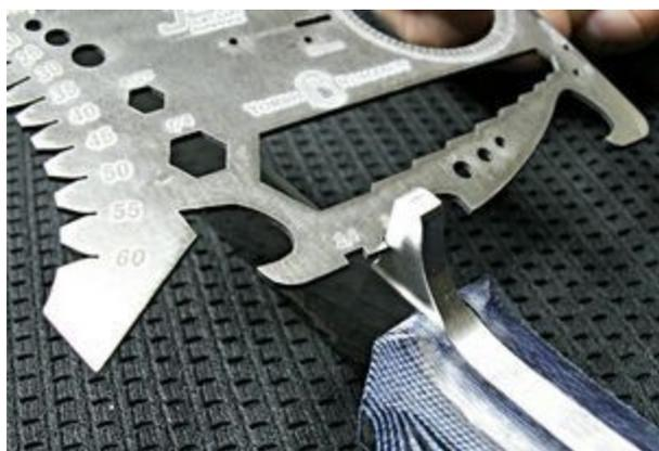
Этот параметр, в основном, относится к ножам по технологии фултанг (сделанным из единой полосы металла, которая проходит через всю рукоять). Если толщина полосы не более 3,4мм, то и толщина упора тоже. Кроме того, многие ножи подогнаны под ГОСТ в результате уменьшения толщины в районе упора.
