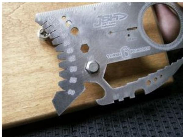
15. Приспособление для зачистки проводов и изгибания проволоки (6 отверстий различного диаметра)
